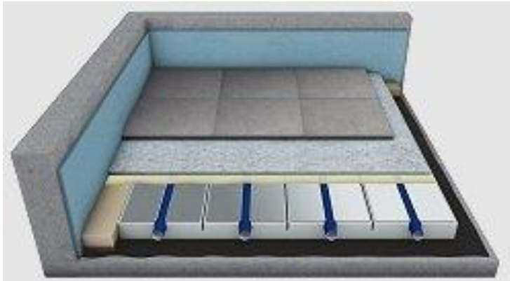
Figuur 2.9 Vloerverwarming in bestaande bouw, bron: droogbouw-vloerverwarming.nl
